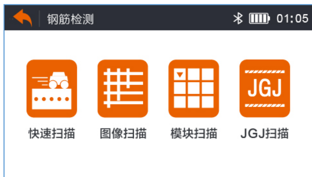
图 3.2 钢筋检测界面
