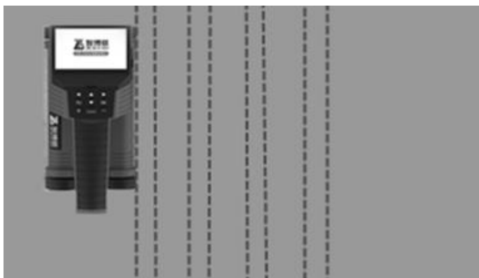
b)仪器和钢筋的不正确距离
