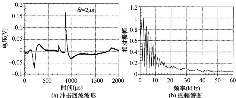
图 7 无效的冲击回波检测示图
